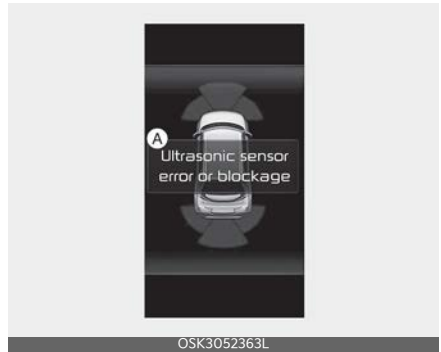
A: Ultrasonic sensor error or blockage
