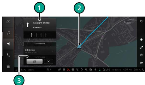
**[1] LANE/TURN NOTIFICATION (車線/右左折の通知):** ポップアップ ウィンドウが開き、次の右左折地点または車線変更地点が右左折地点までの距離と共に表示されます。
