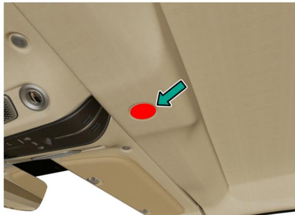
11. ルーフ緊急ツールの細い方の端を使用してルーフ モーターのスクリュー (F) を取り外します。
