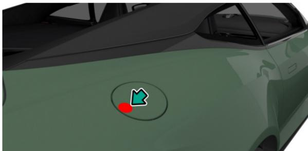
燃料タンクは燃料が入りすぎない構造になっていますが、満タンになる前に給油ノズルが停止する場合があります。そうした場合には、一回だけ再給油を試みてください。それ以上給油を試みると燃料があふれ出すおそれがあります。10秒待つて給油ノズルを抜いてください。
