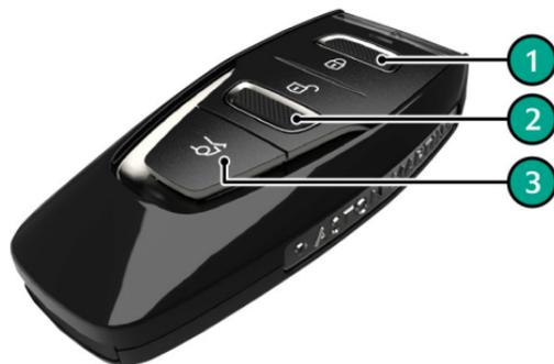
**[1] ロック:** 車両がロックされ、セキュリティシステムが起動します。
