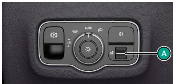
日中におけるインストルメント（計器）用照明の明るさは、デフォルトで最大に設定されます。夕方と夜間の照明は、フロントガラス最上部にあるトワイライトセンサーによって規定の水準まで自動的に暗くなります。
