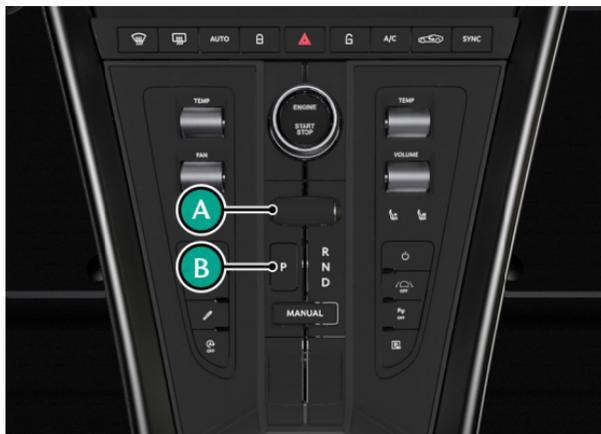
オートマチックモードでは、ドライブモードはロアコンソールのトランスミッションセレクターレバー(A)で選択します。前進中は、車速、現在選択されているギア、加速の必要性などのさまざまな条件に応じて自動的に変速が行われます。停車状態では、アクセルを踏むとすぐに発進できるよう1速ギアが選択されます。
