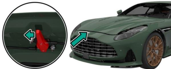
ボンネットを閉めるには、自重で下がる位置まで下げた後、ボンネットから手を放して落下させます。この操作でボンネットが閉まらないときは、ボンネットを再び開き、落下させながら手で軽く押しします。
