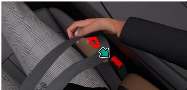
斜めに掛かったベルトを引き上げ、バックルが確実にハマっているか確認し、ベルトのたるみを取り除いてください。
