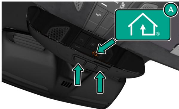
両方のボタンを放します。以上で3個のボタンの設定がすべて消去され、HomeLink システムは設定モードに入ります。
