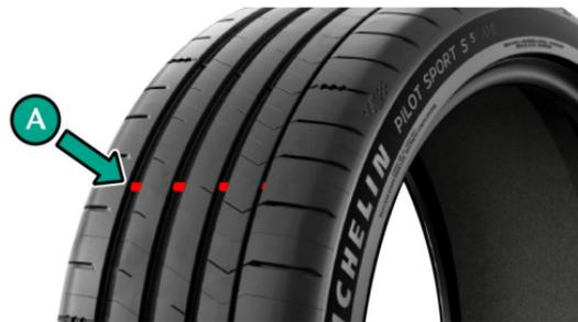
タイヤが摩耗し、一か所以上でインジケータがトレッドと同じ高さになったならば、タイヤは摩耗限界に達しています。国によっては摩耗限界に達したタイヤの使用は違法とみなされ、タイヤ交換が必要になります。
