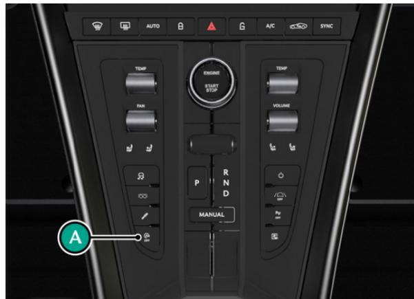
ストップ/スタート機能は、ロアコンソールの
