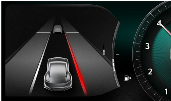
一方の前輪が車線境界線を越え、走行車線をはみ出すと、車線逸脱警告による最初の警告としてステアリング ホイールが振動し、インストルメント クラスタに警告が表示されます。ドライバーがその警告に反応しないと、次の段階として車線キープ アシストシステムが起動し、左右いずれかの前輪を瞬間的に制動し、車両を適切な車線に戻します。
