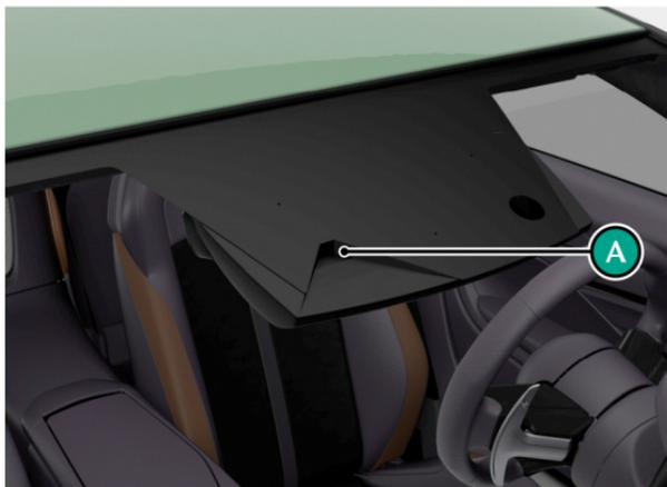
そうしたドライビング システムが正常に働くためには、カメラ前方のフロント ガラス部分を清潔な状態にしておく必要があります。カメラはワイパー ブレードの拭き取り範囲内にあるため、悪天下ではワイパーを作動させるとその部分も清掃されます。夏季などの乾燥が長く続く季節では、フロント ワイパーを定期的に使用して汚れや埃が溜まるのを防いでください。
