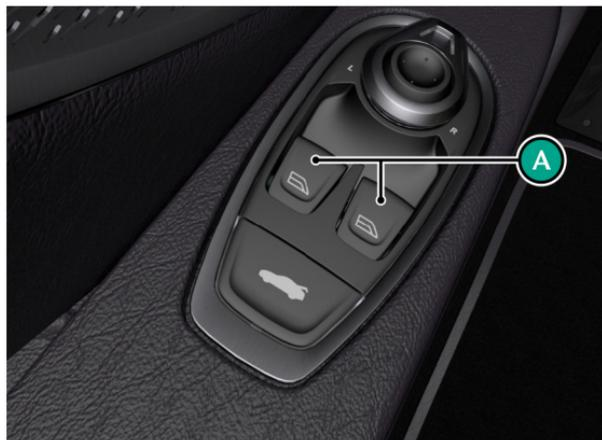
ウィンドウ スイッチを押すか、抵抗に逆らって引くと、ウィンドウをワンタッチ操作で開閉できます。
